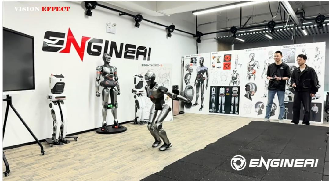
de 23 degrés de liberté, il pèse 40 kg pour 138 cm et atteint une vitesse de 7,2 km/h. Il intègre un capteur Intel RealSense D435i et fonctionne sur un système open-source, propulsé par des puces Intel N97 et Nvidia Jetson Orin. Sa batterie amovible de 10 000 mAh lui confère environ deux heures d'autonomie.
