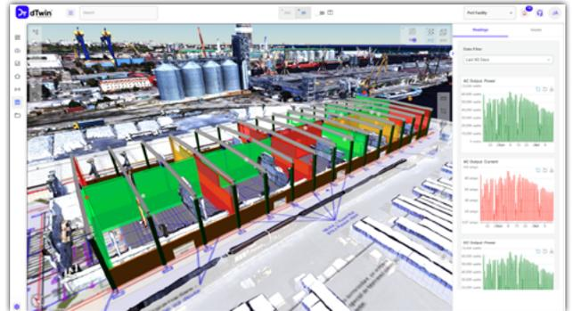
structure des bâtiments et la consommation d'énergie sont disponibles. Ce système permet une surveillance complète du processus de déchargement des navires, améliorant ainsi durablement l'efficacité énergétique et la productivité, au bénéfice des clients.
