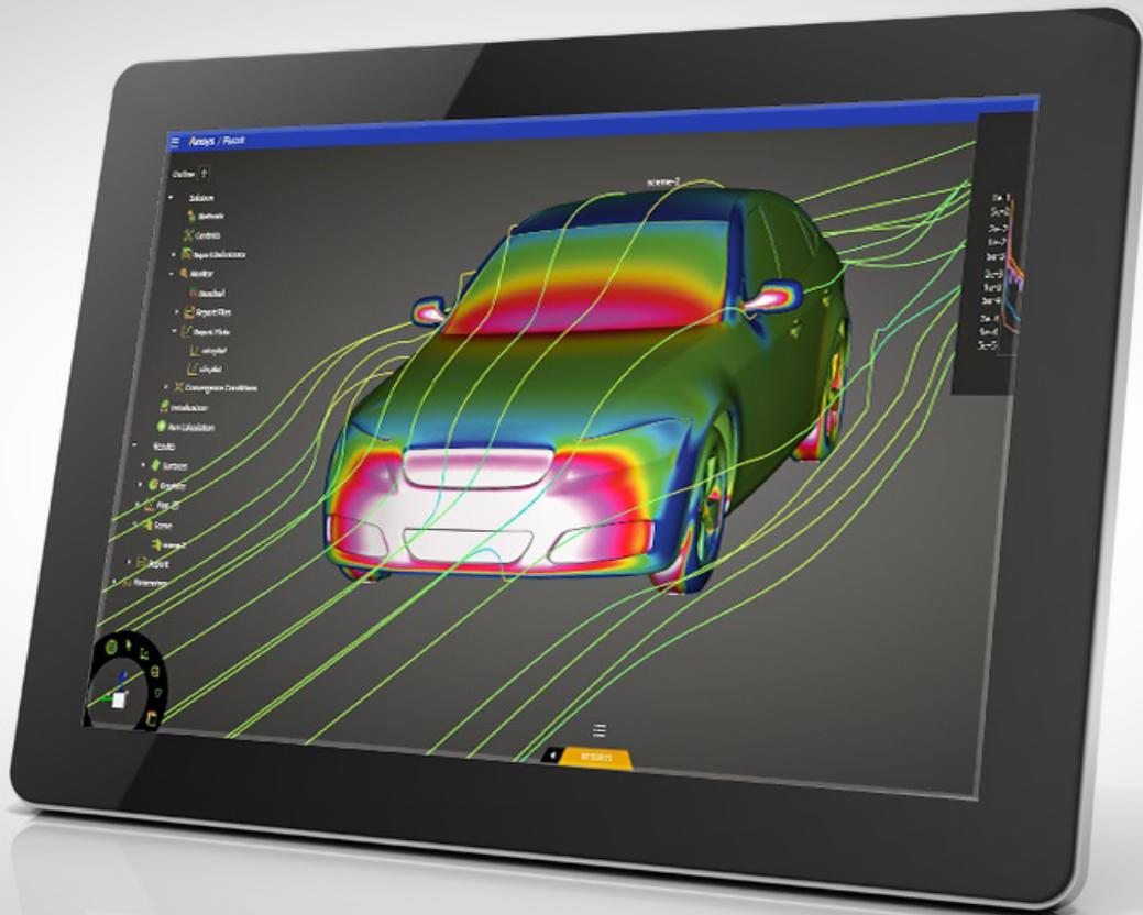
La nouvelle interface Web Ansys permet d'accéder aux solveurs de mécanique des fluides de l'éditeur fonctionnant dans le cloud, et depuis n'importe quel device.
