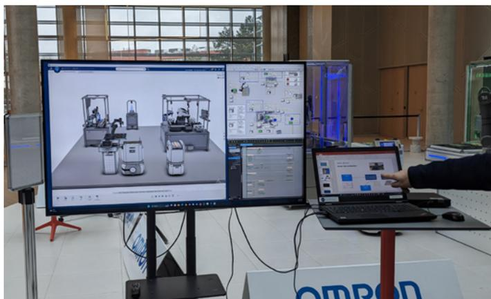
← La simulation de la cellule de production permet d'optimiser son fonctionnement, les flux de pièces et de tester de nouveaux scénarios.
